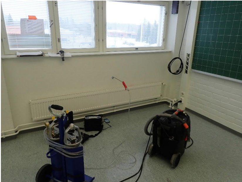
Kuva 7: Merkkiainekaasua syötettiin ulkoseinärakenteeseen ikkunoiden alapuolelle tilassa 205.
